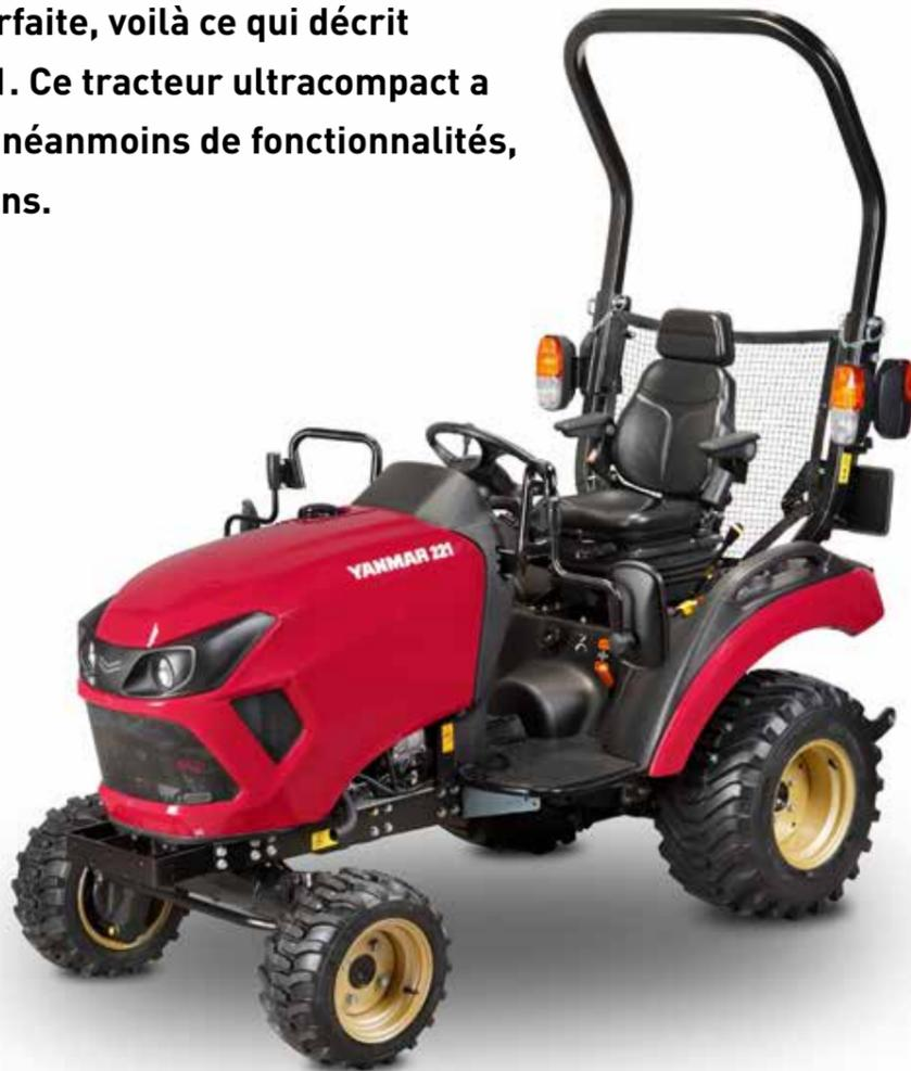
un moteur monté sur isolateurs et un châssis intégral qui minimisent les vibrations dans le compartiment de l'opérateur.
