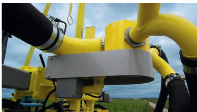
◀ Entraînement des rotors par moteurs hydrauliques drainés. Capteur de vitesse de rotation électronique intégré.
