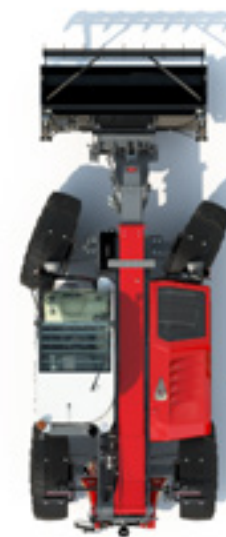
Mode de direction À DEUX ROUES
