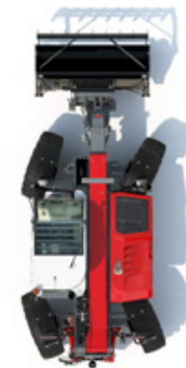
MODE DE DIRECTION à quatre roues – pour des rayons de braquage restreints.
