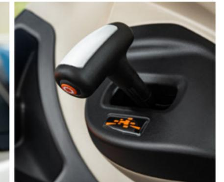
L'inverseur exclusif **Power Control** assure une utilisation trois-en-un en toute simplicité. L'utilisateur peut inverser le sens d'avancement ou sélectionner le point mort tout en gardant sa main droite libre pour les commandes hydrauliques du chargeur ou de l'outil.
