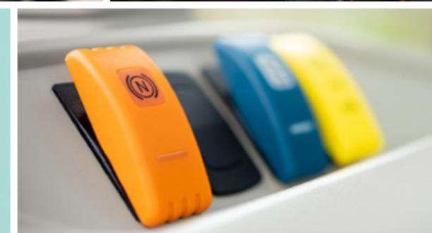
L'activation de la **fonction « neutre pédale de frein »** permet d'actionner également l'embrayage dès que la pédale de frein est enfoncée.
