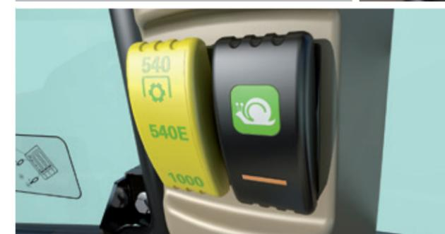
Des **vitesse super rampantes** permettent de réduire la vitesse de travail à 140 m/h seulement (à 1 400 tr/min avec des pneus 420/85 R34), pour mener à bien des tâches spécifiques.
