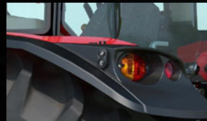
Les commandes externes situées sur les ailes facilitent la montée et la descente du relevage arrière lors de l'attelage ou du dételage d'outils.
