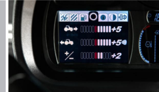
Pour les applications nécessitant des vitesses d'avancement particulièrement lentes, un contrôle ultra-précis est assuré par des **vitesses rampantes supplémentaires** qui permettent d'atteindre une vitesse de 100 m/h à 1 400 tr/min.
