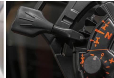
L'inverseur **Powershuttle** permet d'inverser le sens de marche du bout des doigts, sans utiliser la pédale d'embrayage.
