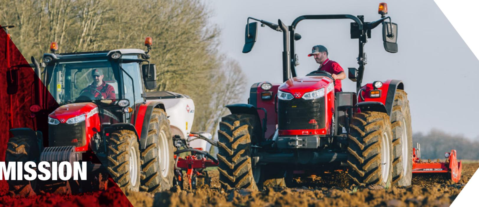
Cette **transmission synchronisée** offre au total douze vitesses en marche avant et douze vitesses en marche arrière sur deux gammes. Six vitesses se trouvent dans la plage de travail au champ de 7 à 15 km/h, et la vitesse maximale est de 40 km/h.
