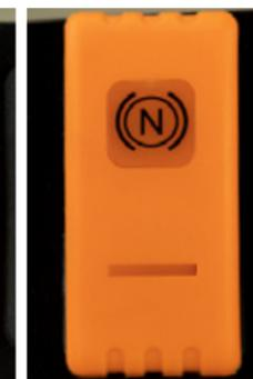
L'**inverseur Powershuttle** exclusif assure une utilisation trois-en-un en toute simplicité. L'utilisateur peut inverser le sens d'avancement ou sélectionner le point mort tout en gardant sa main droite libre pour commander les distributeurs hydrauliques du chargeur ou de l'outil.
