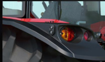
Les commandes externes situées sur les ailes facilitent la montée et la descente du relevage arrière lors de l'attelage ou du dételage d'outils (de série sur la version cabine).
