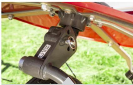
L'angle d'épandage peut être facilement ajusté selon 5 réglages en déplaçant une goupille, en fonction de vos besoins.
