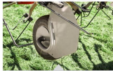
Un système spécial empêche le fourrage de s'enrouler autour de l'arbre de roue.
