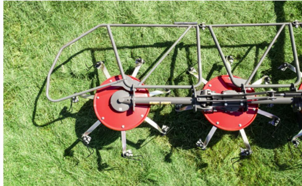
Les rambarde de sécurité en forme de grilles optimisent la protection et renforcent le châssis principal.
