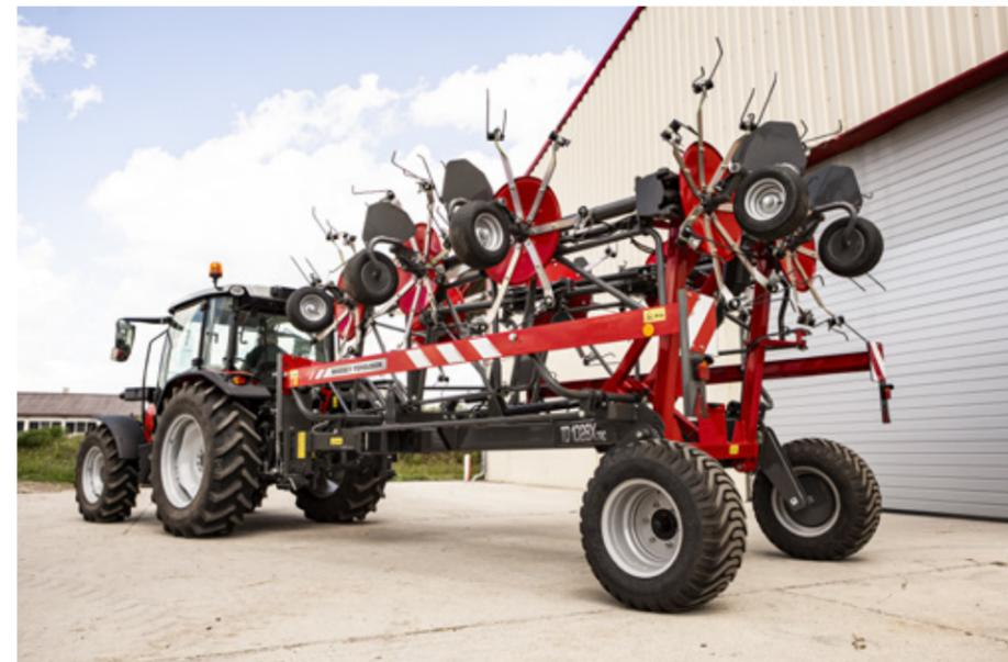
**Mode transport :** pour le transport sur route, les rotors sont positionnés sur le châssis. Les articulations sont ainsi protégées et ne subissent aucune contrainte en position repliée. La position de transport spéciale avec alignement des rotors rend tous les modèles MF TD X suffisamment compacts pour le transport, même les plus larges.
