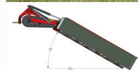
Suspension latérale : fauchage possible sur terrains en pente
