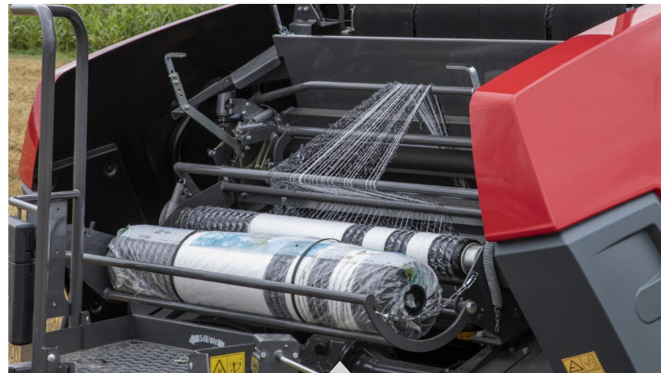
Le **système Easy Loading System (ELS)** permet d'emporter un rouleau de rechange sur la presse pour ainsi pouvoir remplacer le rouleau terminé en quelques minutes. Outre l'ELS, la plupart des modèles intègrent un rangement pour un rouleau de filet supplémentaire sur le côté gauche de la presse afin d'optimiser le temps de travail au champ.
