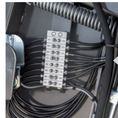
Un graissage suffisant et régulier des roulements à rouleaux est très important, notamment dans des conditions difficiles comme le pressage d'ensilage. Les banques de graisseurs centralisées destinées au graissage des roulements à rouleaux sont stratégiquement situées, pour un accès facilité et un temps d'entretien réduit.
