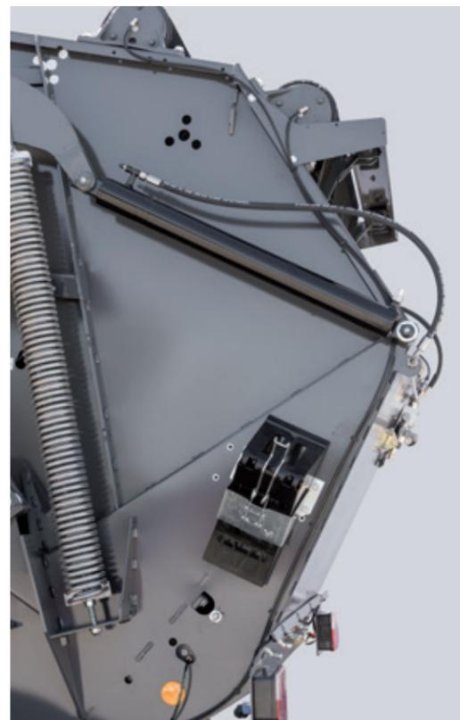
Le volume de la balle augmente exponentiellement par rapport à son diamètre, avec une pression de courroie correspondante, afin de maintenir une densité de balle constante.
