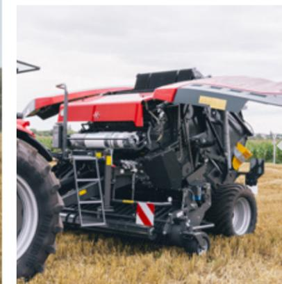
Les grands capots latéraux pleine largeur facilitent l'accès pour l'entretien. La conception avec une surface lisse évite l'accumulation de saletés sous les panneaux tandis que le verrouillage de sécurité évite les ouvertures accidentelles et les éventuels dommages.
