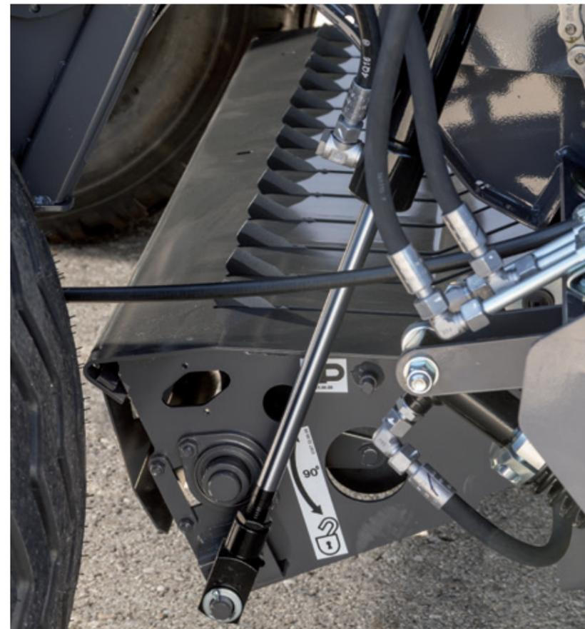
La première fonction du système Hydroflexcontrol permet de déplacer la partie avant du fond de la chambre d'alimentation et d'éviter automatiquement jusqu'à 80 % des bourrages potentiels, pour continuer à travailler sans temps d'immobilisation inutiles.
