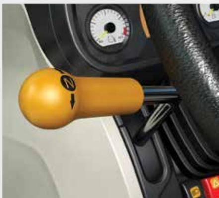
Le passage de la marche avant à la marche arrière, au champ, en fourrière ou dans votre cour pendant les opérations de maintenance est grandement facilité par un levier d'inverseur mécanique synchronisé. Intelligemment placé sur la gauche du tableau de bord, il offre un remarquable confort pour inverser le sens d'avancement.
