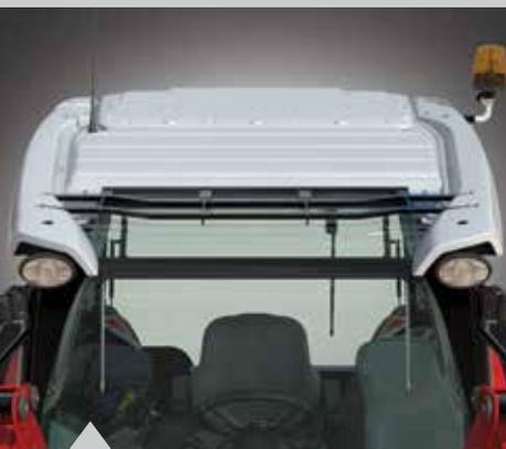
**Toit haute visibilité avec protection contre les chutes d'objets (FOPS)**
