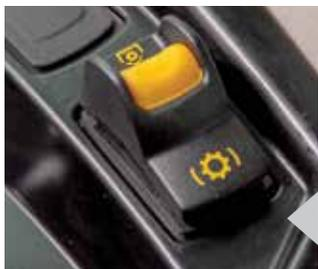
L'activation de la prise de force reste électro-hydraulique avec le même contacteur de sécurité à 3 positions (arrêt, marche et blocage/frein).
