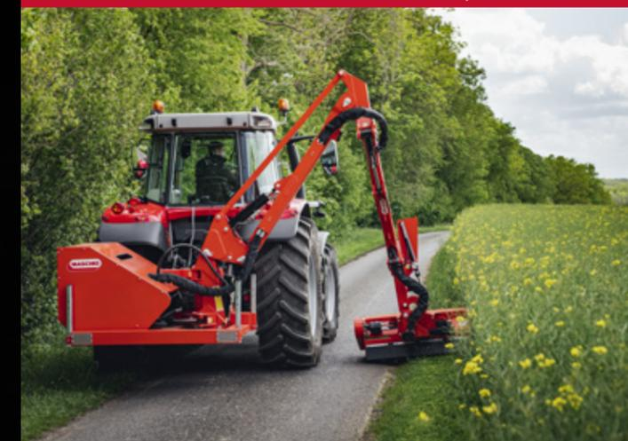
La cabine panoramique de la série MF 6S offre une visibilité dégagée sur le côté droit de la machine pour un contrôle sûr et efficace des outils utilisés latéralement. La vitre en polycarbonate hautement résistante protège l'opérateur des projections de débris.
