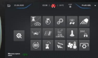
Des fonctions regroupées pour optimiser la gestion de votre tracteur, notamment la transmission, le moteur et le système hydraulique. Sans oublier le système Dual Control, qui offre le contrôle des relevages avant et arrière simultanément à l'aide de la même commande. Ce système ajuste également la profondeur du relevage arrière ainsi que celle de la roue de jauge d'une charrue par exemple.
