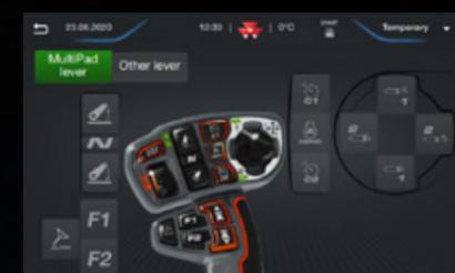
Choix de commande MultiPad pour ISOBUS – Les outils ISOBUS peuvent être contrôlés directement avec le levier MultiPad. Tout contrôler (tracteur et outil) à partir d'un seul levier est bien plus simple que d'utiliser différentes commandes et différents affichages.
