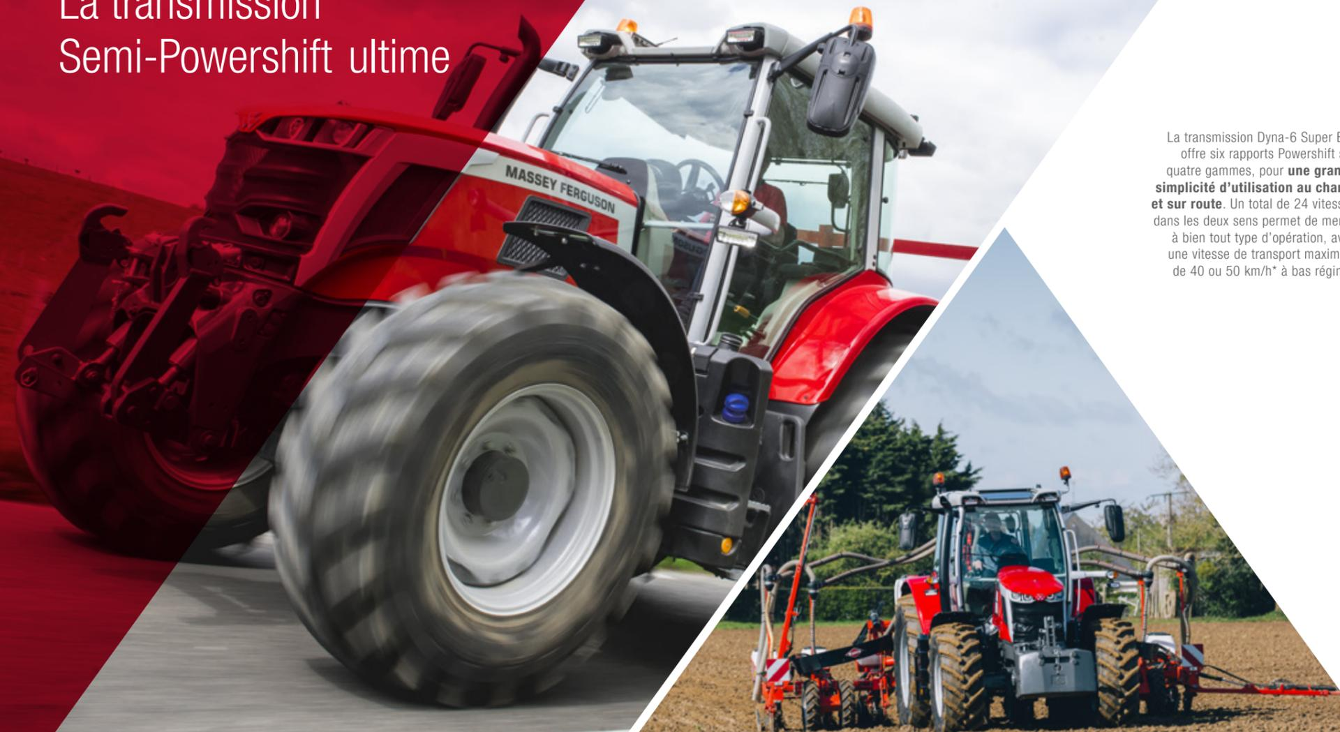
La transmission Dyna-6 Super Eco offre six rapports Powershift sur quatre gammes, pour **une grande simplicité d'utilisation au champ et sur route**. Un total de 24 vitesses dans les deux sens permet de mener à bien tout type d'opération, avec une vitesse de transport maximale de 40 ou 50 km/h\* à bas régime.
