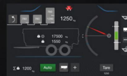
La nouvelle fonction de contrôle automatique MF E-Loader contribue à améliorer la précision, la productivité et la sécurité. Elle est dotée d'un système de pesée. Elle enregistre également le poids total de chaque élément, charge ou tâche et transfère les données sous forme de simple feuille de calcul. L'utilisateur peut configurer et enregistrer des séquences automatiques pour différents cycles de chargement. MF E-Loader offre également une fonction utile de secouage du godet.
