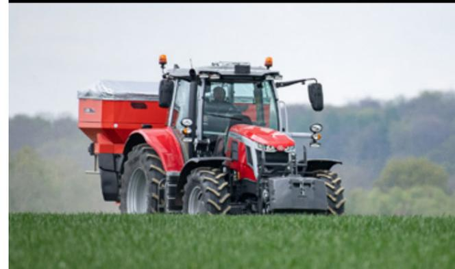
Avec ses dimensions compactes, son châssis spécial et son empattement de 2,67 m, la série MF 6S est extrêmement maniable, polyvalente et robuste.
