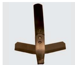
Soc lame DURASTAR avec ailerons rechargés
